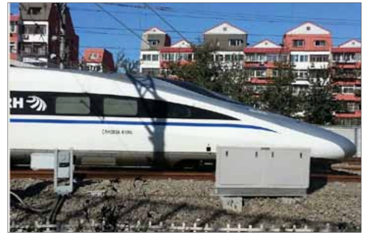
滚动轴承早期故障轨边声学诊断系统
