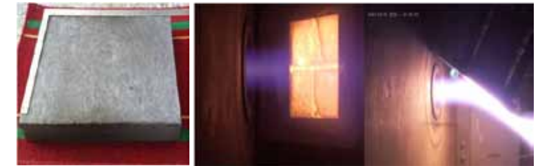
风洞试验证明：材料在2000℃火焰冲刷后，背温不超过50℃
