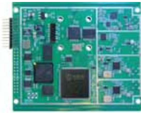
工业级、全数字GNSS信号基带处理器
